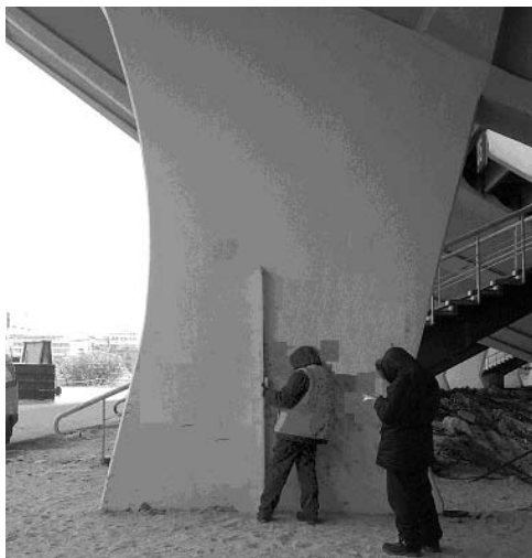
Рисунок 5. Проведення вимірювання рейкою-виском
